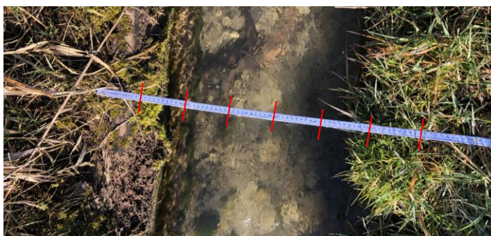
Abb. 2 Messung Gerinnebreite Mattebächli, rote Striche markieren je 10 cm
